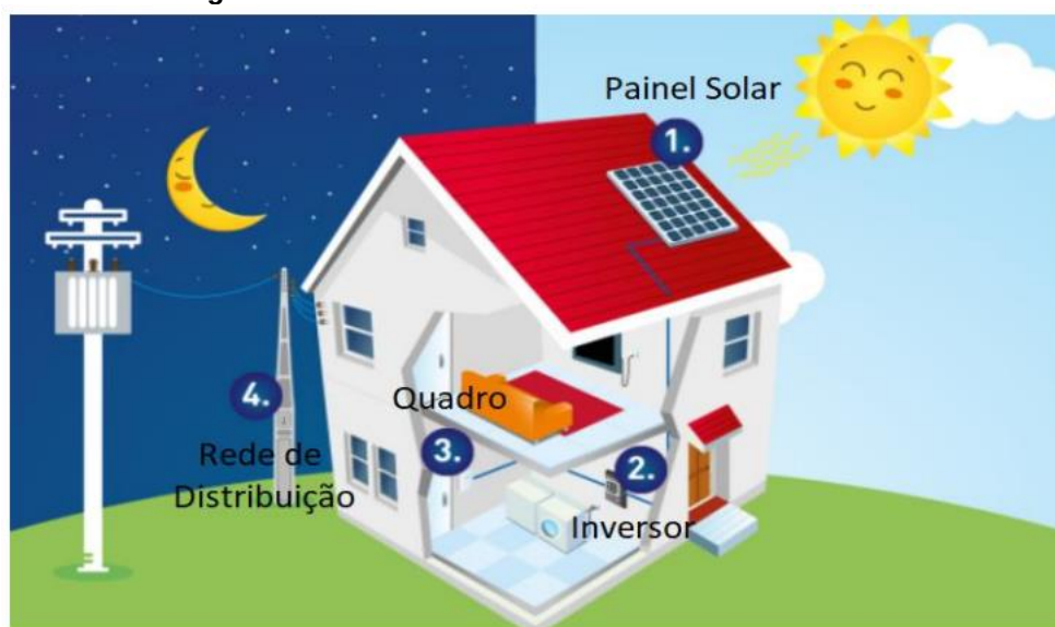
Figura 8: Estrutura de um sistema fotovoltaico On-Grid.
