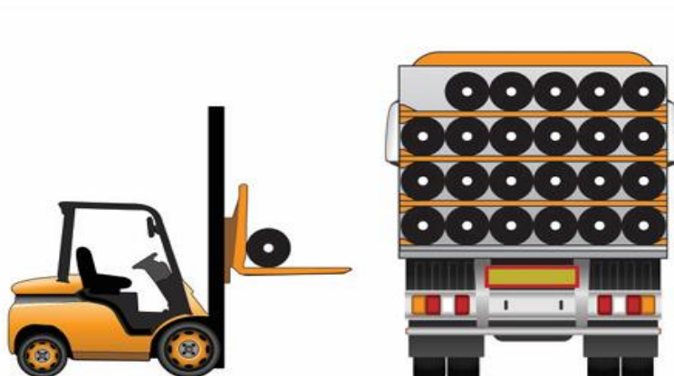
Figura 16: Descarregamento/carregamento de bobinas de geomembranas
