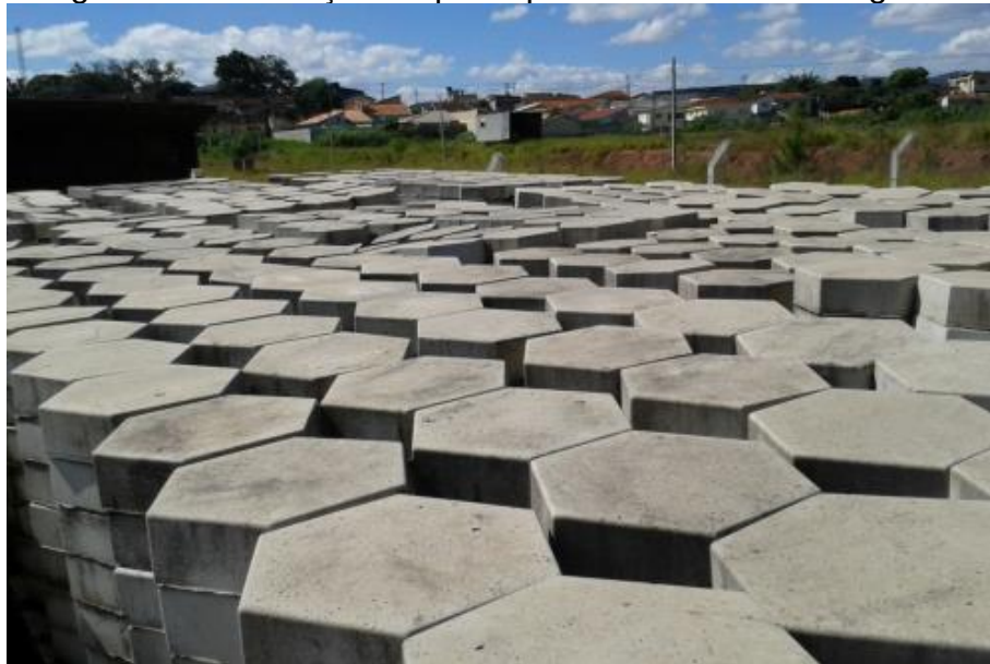
Figura 10 – Produção de piso tipo sextavado ou hexagonal.
